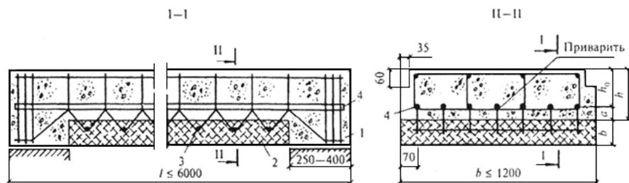
1 - тяжелый жаростойкий бетон; 2 - теплоизоляционный слой из легкого жаростойкого бетона;
