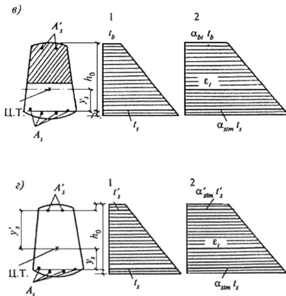
а - бетонного и железобетонного без трещин; б - железобетонного с трещинами в растянутой зоне, расположенной у менее нагретой грани; в - то же, у более нагретой грани; г - железобетонного с трещинами по всей высоте сечения; Ц.Т. - центр тяжести приведенного сечения
