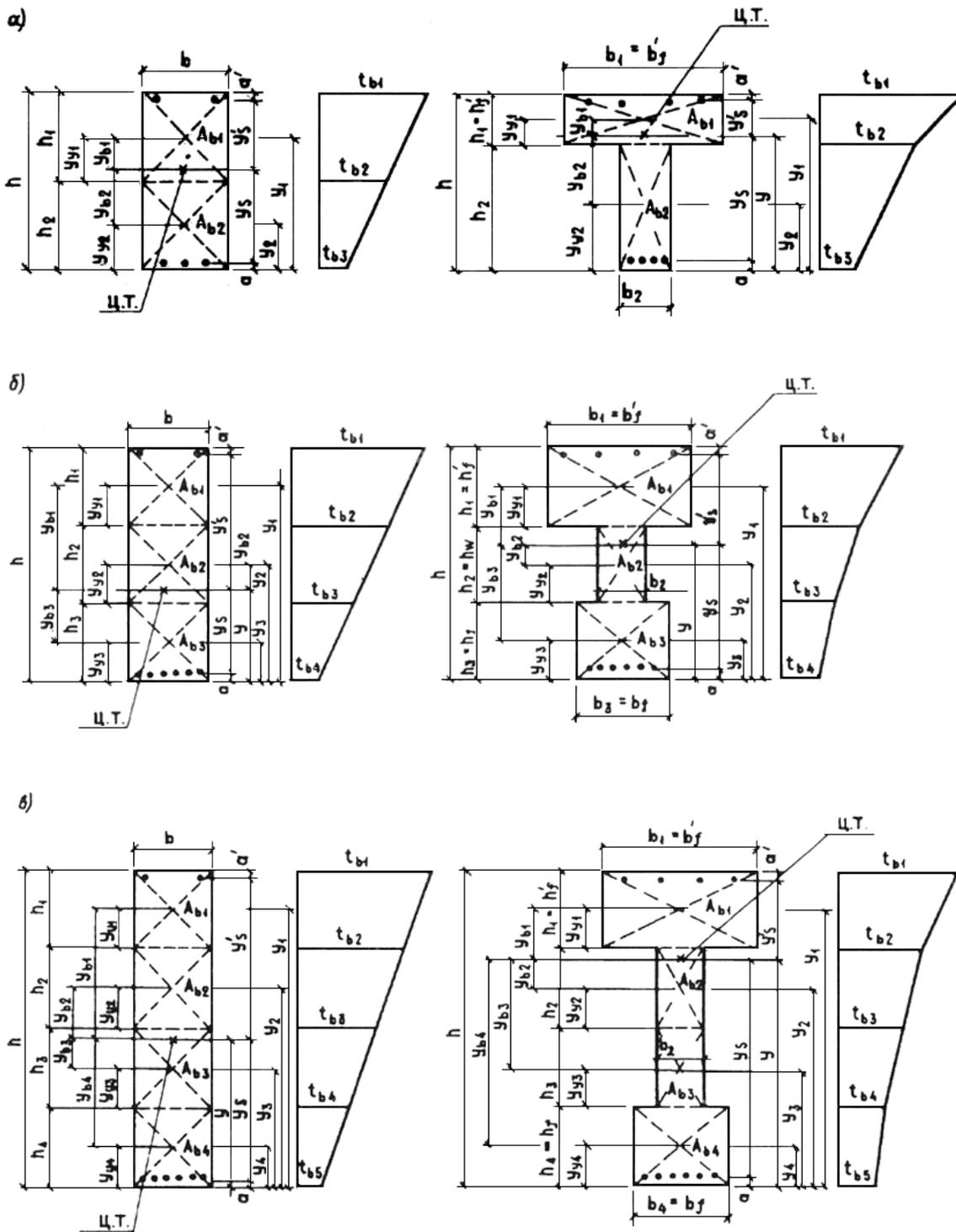
а - на 2 части; б - на 3 части; в - на 4 части; Ц.Т. - центр тяжести приведенного сечения;  $t_{b1}, t_{b2}, \dots, t_{bi}$  - наибольшая температура бетона 1-й, 2-й, ...,  $i$ -й частей сечения
