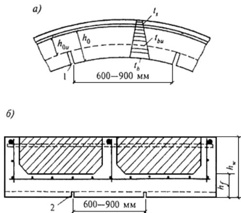
а - компенсационные; б - усадочные; 1 - компенсационный шов шириной 2-5 мм; 2 - усадочный шов глубиной  $0,1 h_0$  и шириной 2-3 мм
