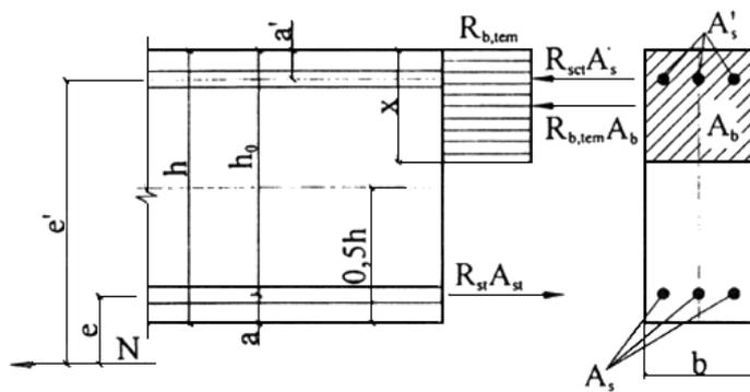
а - продольная сила  $N$  приложена между равнодействующими усилий в арматуре  $S$  и  $S'$ ; б - то же, за пределами расстояния между равнодействующими усилий в арматуре  $S$  и  $S'$ .
